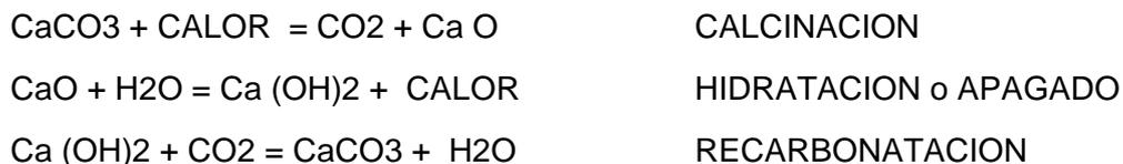
Origen : la materia prima para la fabricación de la cal es la piedra caliza que cuando es pura esta constituida enteramente por carbonato de calcio y al ser calcinada da origen a las cales aéreas .Cuando presenta impurezas arcillosas es la roca adecuada para la obtención de las cales hidráulicas.
